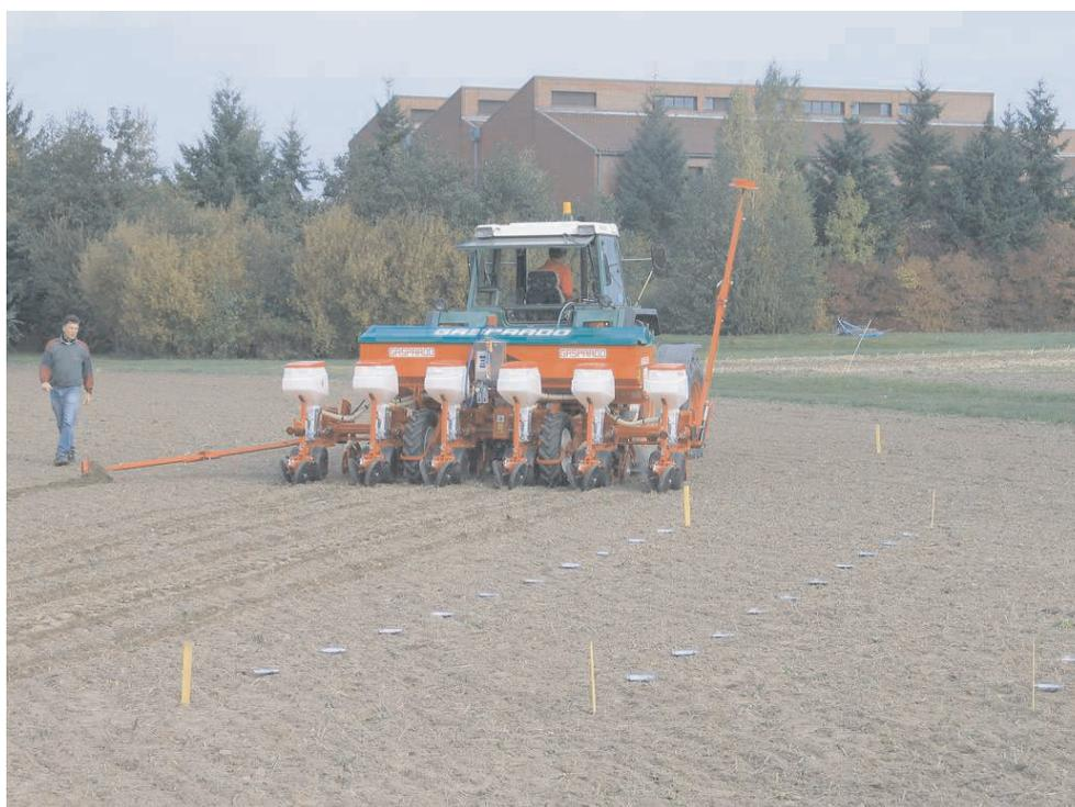
**Abb. 3.** Traktor mit Maiseinzelkornsäuger bei Abdriftmessungen im Freilandversuch.
