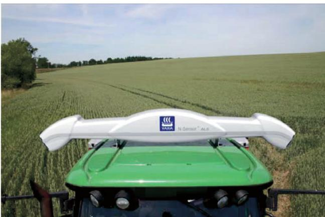
Abb. 5. YARA N-Sensor ALS auf dem Schlepperdach.
