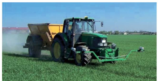
Abb. 6. Greenseeker im Frontanbau des Schleppers.
