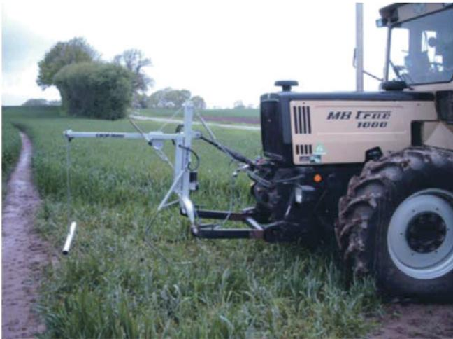
Abb. 3. Cropmeter (Pendelsensor) im Frontanbau des Traktors.
