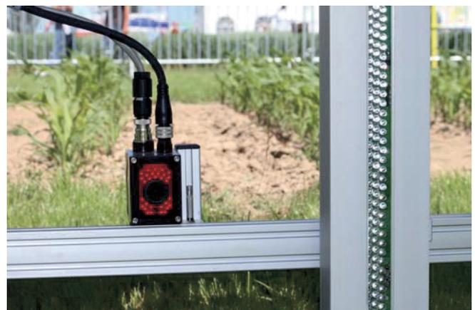
Abb. 1. Bildgebende Sensorsysteme im Feldeinsatz: 3D-Time-of-Flight Kamera (links) und bildgebendes Lichtgitter (rechts).
