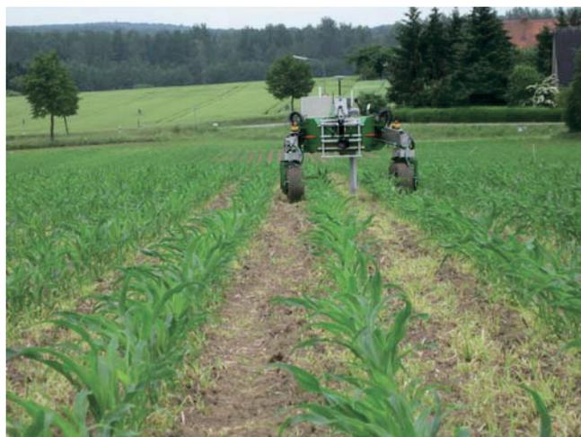
Abb. 6. Autonomer Feldroboter BoniRob mit Applikationsmodul zur Feld-Pflanzenphänotypisierung.
