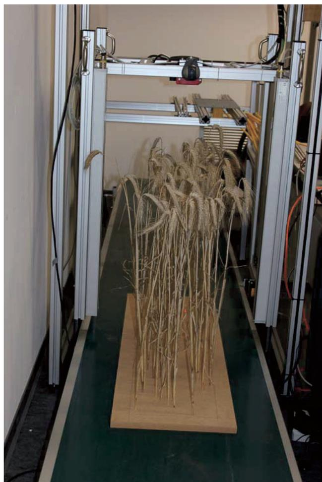
Abb. 3. Förderband zur Entwicklung von Sensor/Daten-Fusions-Algorithmen (Hochschule Osnabrück, COALA).
